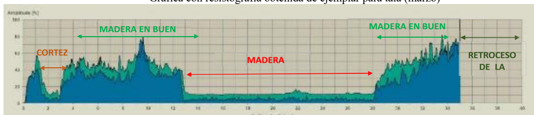
Gráfica con resistografía obtenida de ejemplar para tala (marzo)
